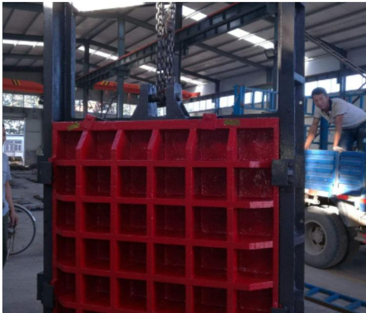
，承包人应会同监理人对平面闸门进行试验和检查。试验前应检查并确认自动挂脱梁挂脱钩动作灵活可靠；充水装置在其行程内升降自如、密封良好；吊杆的连接情况良好。平面闸门的试验项目包括：（1）无水情况下全行程启闭试验。试验过程检查滑道或滚轮的运行无卡阻现象，双吊点闸门的同步应达到设计要求。在闸门全关位置，水封橡皮无损伤，漏光检查合格，止水严密。在本项目试验的全过程中，必须对水封橡皮与不锈钢水封座板的接触面采用清水重淋润滑，以防损坏水封橡皮。（2）静水情况下的全行程启闭试验。本项试验应在无水试验合格后进行。试验、检查内容与无水试验相同（水封装置漏光检查除外）。（3）动水启闭试验。对于事故闸门、
